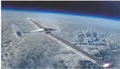
Dank der großen Spannweite von 44,9 Metern und 22 Quadratmetern Solarzellen will Solarstratos abheben. (Bild: Solarstratos)
