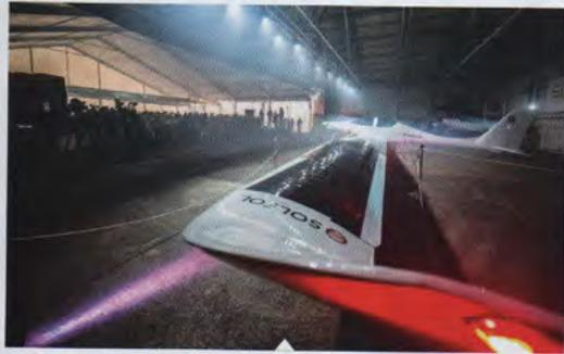
SolarStratos porte 22 mètres carrés de panneaux solaires sur sa voilure.
