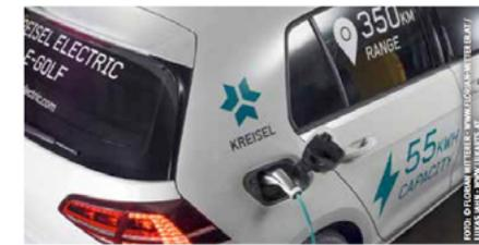
Der elektrische Golf von Kreisel Electric besitzt eine Kapazität von 55,7 kWh und kann in nur 20 Minuten zu 80 Prozent aufgeladen werden
