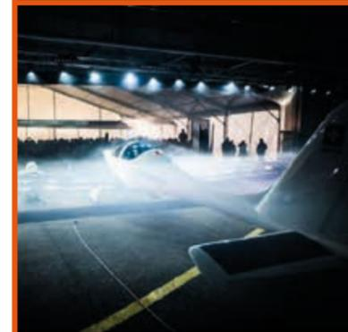
SolarStratos a pour ambition de devenir le premier avion commercial biplace fonctionnant uniquement à l'énergie solaire à aller dans la stratosphère. Dévoilé mercredi 7 décembre, l'avion fait 8,5 mètres de long pour 24,8 mètres d'envergure. Ces 450 kilogrammes disposent de 24 heures d'autonomie grâce à une batterie lithium-ion de 20 kWh et 22m<sup>2</sup> de cellules solaires.
