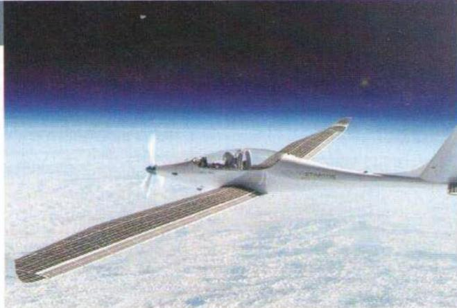
l'initiateur du projet, Raphaël Domjan, revêtu d'une combinaison d'astronaute (empêchant tout saut en parachute), car la cabine n'est pas pressurisée. Ce test se décomposera en 2 heures de montée, 15 minutes de vol horizontal et 3 heures de descente ■
